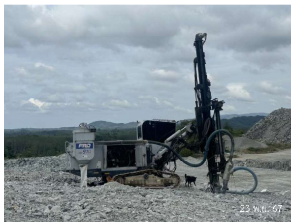
ภาพถ่ายที่ 2-10 ใช้เครื่องเจาะรูระเบิด
